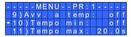
9) Avv. a Temp - Avvitatura a tempo. Permette di impostare un'avvitatura a tempo da OFF a 20.0 sec. Al raggiungimento del tempo impostato si avrà un segnale di vite corretta.
