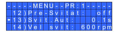
**12) Pre-Svitat. - Pre-svitatura**. Permette di svitare prima di eseguire l'avvitatura. Il tempo è impostabile da OFF a 20.0 sec.
