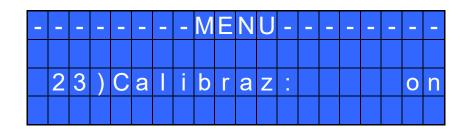
3. Scegliere OK per confermare. Se si sceglie OFF si interrompe la calibrazione e sul display non si visualizzerà il valore di coppia. Se si sceglie ON si continua e si passa alla schermata successiva.
