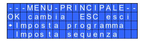
**Impostare programma**: Indica la sezione del Menu dove si possono modificare le impostazioni di avvitatura.
