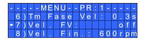
**6) Tm Fase Vel (Tempo Fase Veloce):** Indica per quanto tempo l'avvitatore deve girare alla velocità FV (vedere punto 7) prima di entrare nella fase di precarico in cui l'avvitatore girerà alla Velocità Finale. (vedere punto 8).
