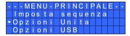
**Opzioni Unità:** Indica la sezione del Menu dove si possono impostare la lingua, password, i pulsanti, l'unità di misura, la modalità di funzionamento dell'unità, la data e ora e visualizzare la versione firmware installata, il numero seriale, e i cicli fatti.
