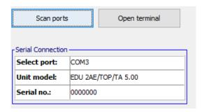
Quando nel riquadro "Serial connection" appariranno la porta, il modello dell'unità e il suo numero di serie, fare click su *Upload to unit*. Nel display dell'unità comparità la scritta "Programming...". Una volta finito il caricamento, la scritta scomparirà, il programma sarà caricato e sarà possibile scollegare il cavo.
